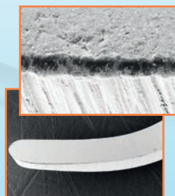
Borde corte de la cureta Sharp Diamond y ampliación del borde tras la prueba.
