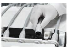
MANGUERAS DE INSTRUMENTOS DE ACOPLAMIENTO RÁPIDO
